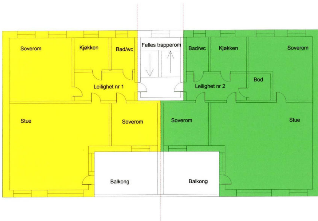
Figur 16 - Tegningen viser BTA av to bruksenheter.
